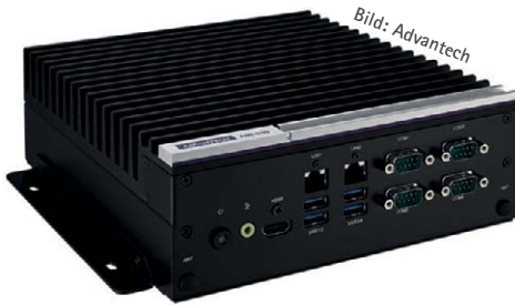
Bild 5: Advantechs KI-Inferenzsystem AIR-030 auf der Basis von Nvidia Jetson AGX Orin
