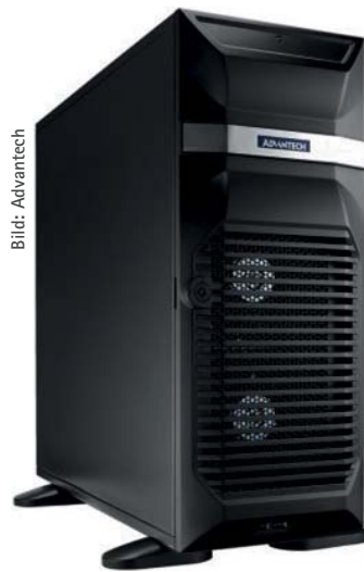
Bild 3: Das auf Nvidia IGX Orin basierende KI-System MIC-735E-IO von Advantech für niedrige Latenz, Netzwerksicherheit und funktionale Sicherheit.
