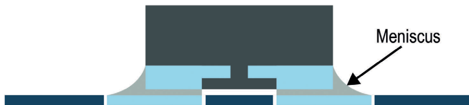
Bild 3: Skizze des Lötmeniskus. Dieser kann mit einem optischen Kamerasystem untersucht werden, um das Lötresultat zu beurteilen.
