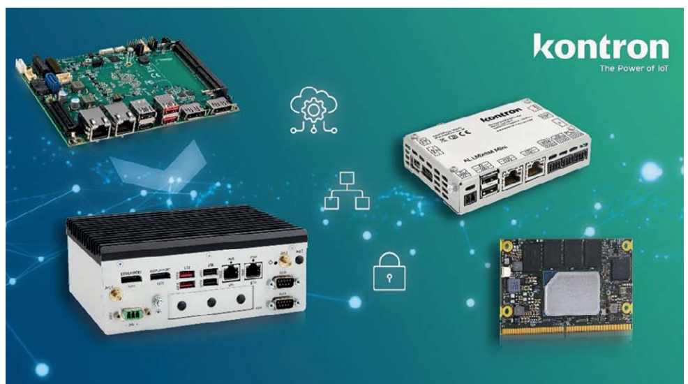
Bild 1: KBox-A-151 mit 3,5"-SBC-AML/ADN (links), der Box-PC AL i.MX8M Mini und das SMARC-sXEL-E2-Modul (rechts)
