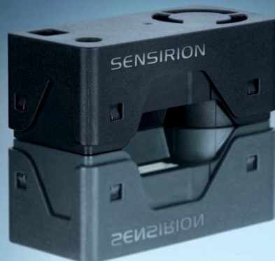
Bild 2: Die kompakte und leistungsstarke Messplattform SEN6x vereint mehrere Sensoren in einem kompakten Gehäuse und kann bis zu neun Umweltparameter messen (PM1, PM2.5, PM4, PM10, RH, T, VOC-Index, NO x -Index, CO 2 oder HCHO). Das Design vereinfacht die Integration, reduziert die Kosten und ermöglicht eine individuelle Anpassung.
