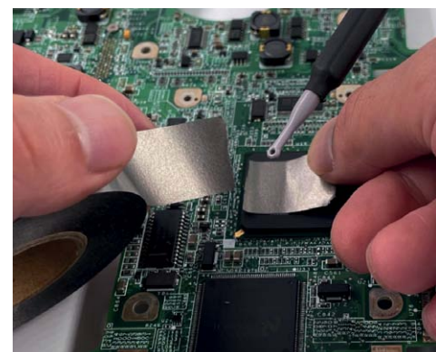
Bild 4: Das EST-Band ist einfach zu handhaben und wird vor allem für die Fehlersuche in der Testphase verwendet.
