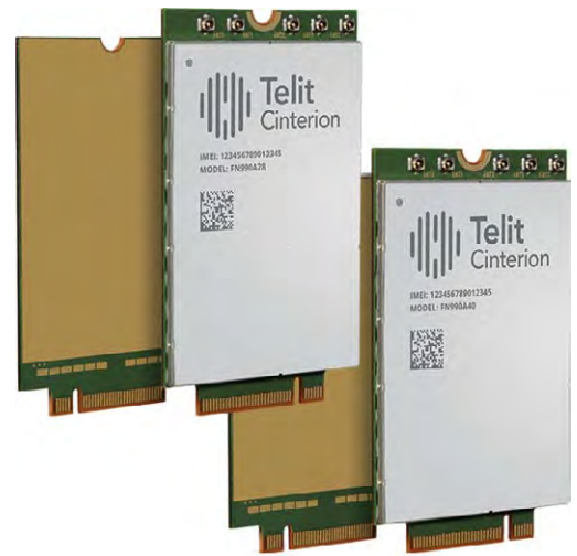
Die M.2-Datenkarten FN990A40 und FN990A28 auf dem Stand der Sub-6-only-Technologie sind für zukunftsichere IoT-Anwendungen und Videos geeignet und bieten alle Vorteile von 5G und Gigabit-LTE.
