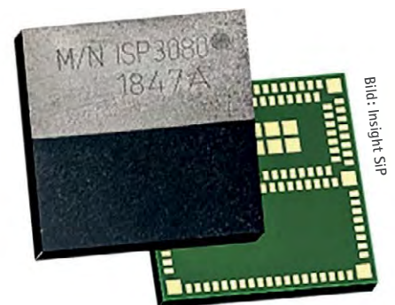
Bild 3: Das ISP3080 von Insight SiP ist ein Standalone-Modul für RTLS-, Zugangskontroll- und Indoor-Positionierungsanwendungen.
