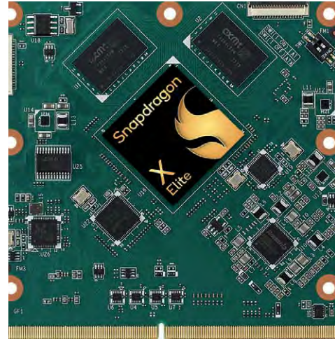
Bild 9: Das AOM-7721 von Advantech wird von einem Qualcomm-X-Elite-SoC für die maschinelle Bildverarbeitung und KI-Anwendungen angetrieben.
