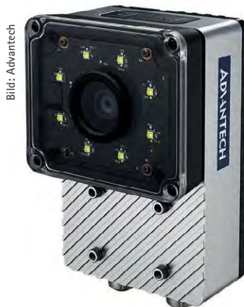
Bild 4: Die ICAM-520 von Advantech ist eine industrielle KI-Kamera, die mit einem Nvidia-Jetson-Xavier-NX-Rechenmodul und einem Sony-Bildsensor in Industriequalität ausgestattet ist.
